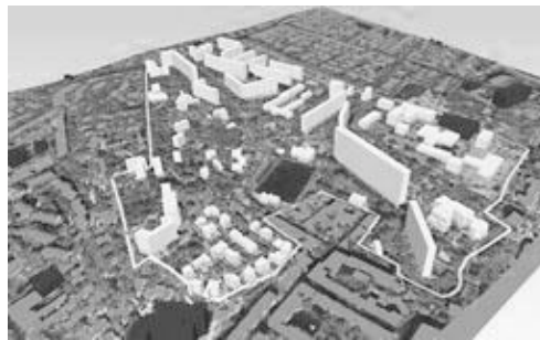
Figure 2. IRIS "PERVENCHES-PROVENCE-HOPKINSON", Marseille - XII e (L'utilisation de l'extension Qgis2threejs permet de produire une maquette 3D, 3D d'une portion de territoire choisie par l'utilisateur)
