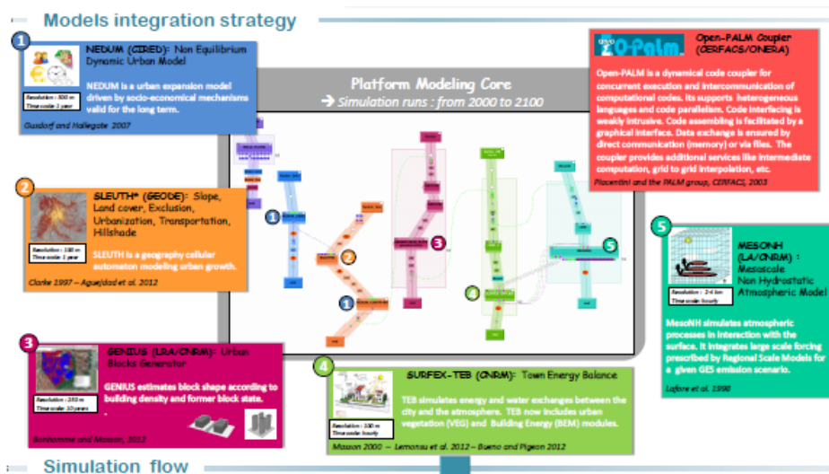
Figure 5 : Le couplage des éléments de la plateforme avec l'outil PALM
