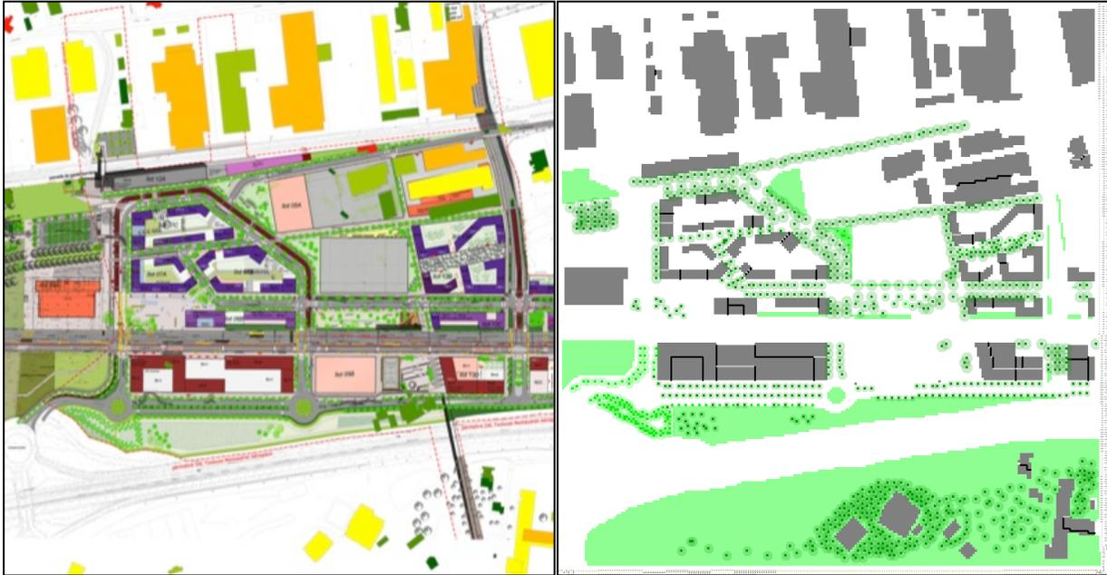
Figure 27 : Partie de la ZAC autour de la Place Centrale (à gauche) et modèle créé à l'aide d'ENVI-met (à droite).
