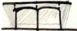
Prolongation de la surtoiture de part et d'autre en rive et jonction en les éléments
