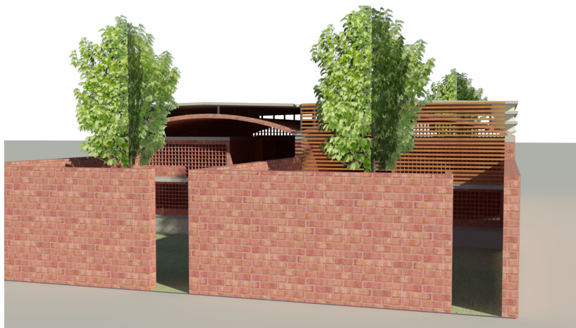
Façade avant avec végétation et système de store d'un côté et brise soleil de Le Corbusier de l'autre
