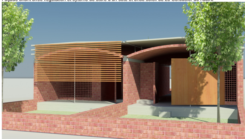
Façade arrière système de store d'un côté et brise soleil de Le Corbusier de l'autre, clôture écorchée partiellement
