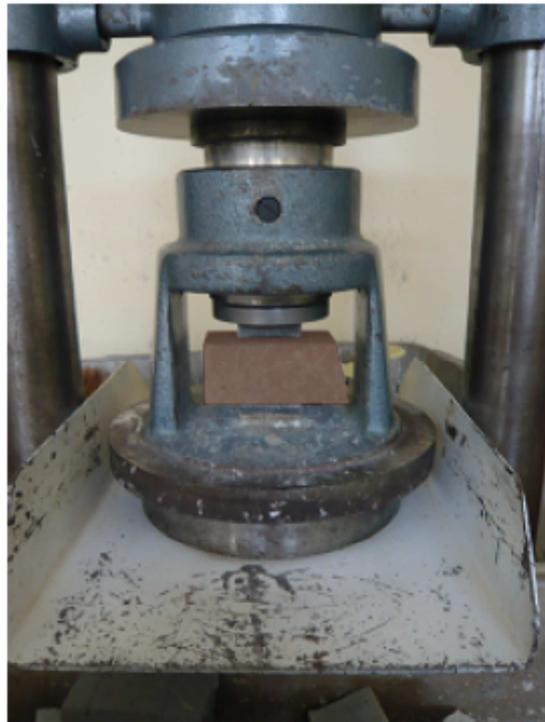
**Figure 9 : Essai de compression**
