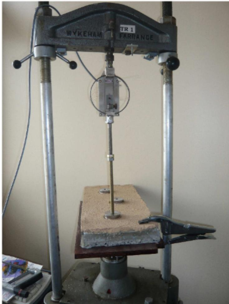
**Figure 11 : Dispositif arrachement à l'aide d'une presse équipée d'un capteur de pression**
