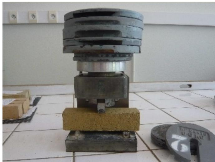
Figure 8 : Essai de flexion réalisé à l'aide de masses de 1 kg
