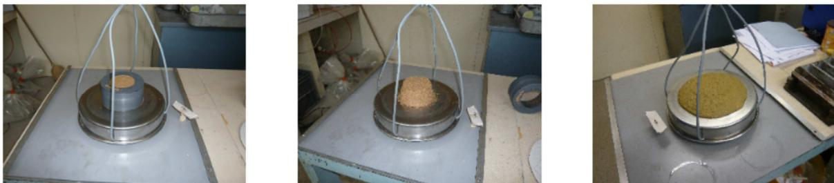
**Figure 5 : Détermination de la consistance du mortier avec la table à secousses manuelle**
