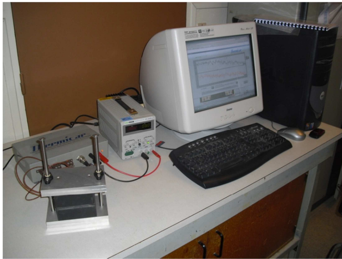
Figure A2 : Appareil de mesure DEsProTherm et dispositif d'acquisition des données
