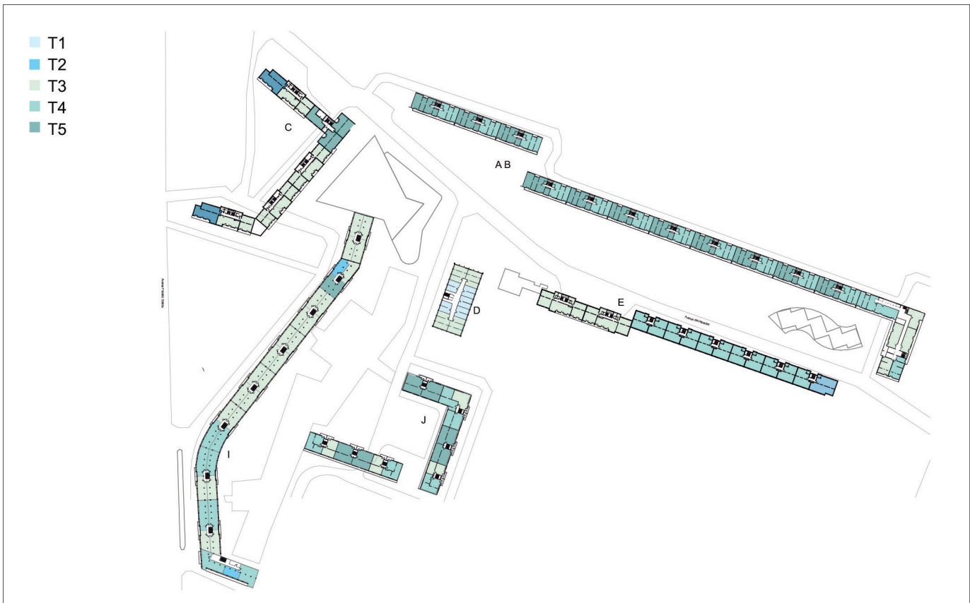
▲ Fig. 4. Composition typologique des Mazades – Les T1 présents uniquement dans la tour ; le T3, typologie dominante (40 % des logements) déclinée en pas moins de 13 logements différents, répartis sur les 7 bâtiments du grand ensemble (© Véronica Albuja).
